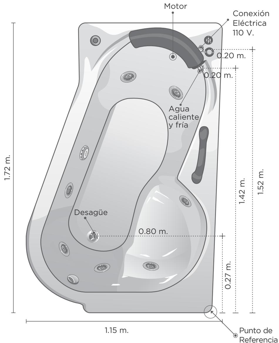
Será necesario proporcionar tres elementos importantes y al alcance del área del equipo para el funcionamiento de la tina.
